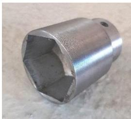
Im Werkzeugkasten eine Nuss mit der Schlüsselweite 42 mm.
